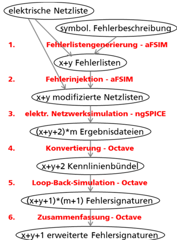
Abbildung 3: Workflow zur Erzeugung von erweiterten Fehlersignaturen. x Anzahl der ADC-, y Anzahl der DAC-Fehler, m Anzahl der Monte-Carlo-Simulationen
